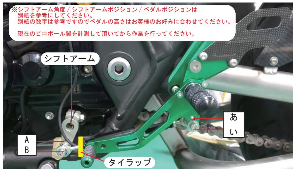
シフトスイッチの配線をシフトロッドにタイラップで仮留めして、シフトロッドを動かし、引っ張り過ぎず、たるまない程度に固定してください。
