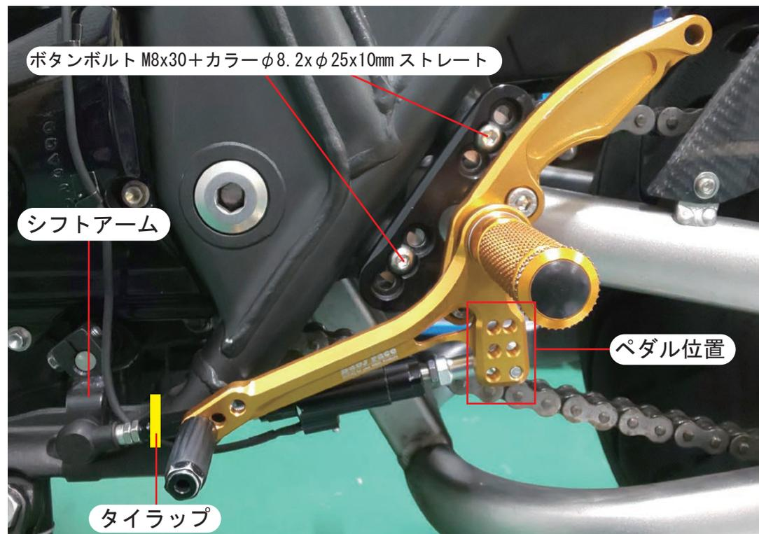
シフトスイッチの配線をシフトロッドにタイラップで仮留めして、シフトロッドを動かし、引っ張り過ぎず、たるまない程度に固定してください。
