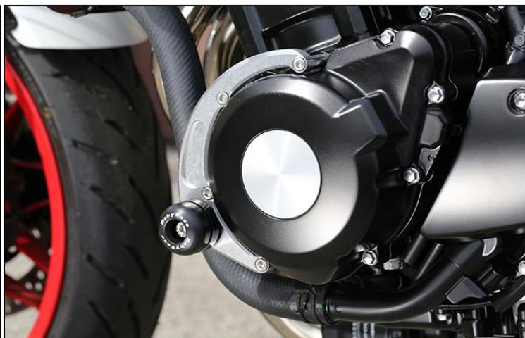
転倒時に破損しやすいクランクケースカバー部を守るエンジンスライダーです。アルミ削り出し製ステーと摩擦係数に優れるジュラコンを組み合わせたボルトオン取り付け可能なスライダーです。左右1台分SET。
