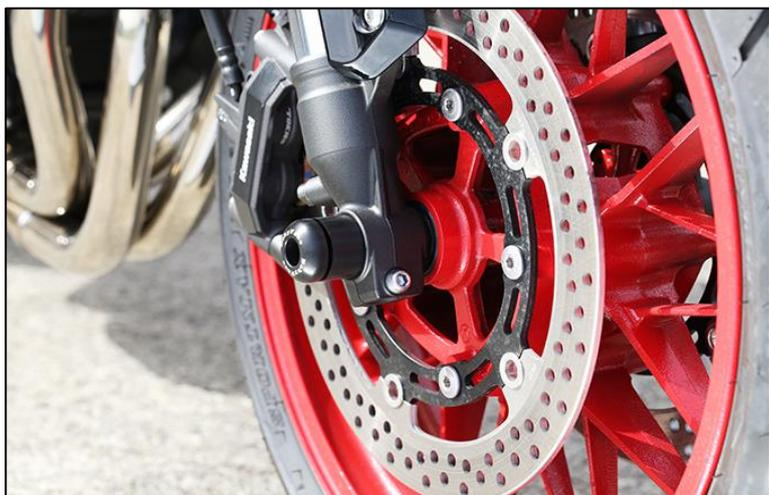
不意の転倒時に破損しやすいフォークボトム部の保護にオススメするスライダーです。倒立フォーク故に、この部分を破損してしまいますと高額な修理費がかさみます。ぜひフレームスライダーと併せてご使用下さい。
