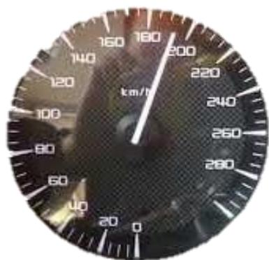
ほとんどの国産車にはスピードリミッター機能が装備されており、180km/h以上の速度が出ないように、点火及び燃料をカットし、速度制御されています。
